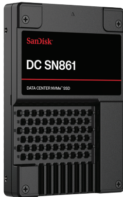
SSD NVMe U.2 de 15 mm/2,5 in 1,60 TB, 1,92 TB, 3,20 TB, 3,84 TB, 6,4 TB y 7,68 TB 1
